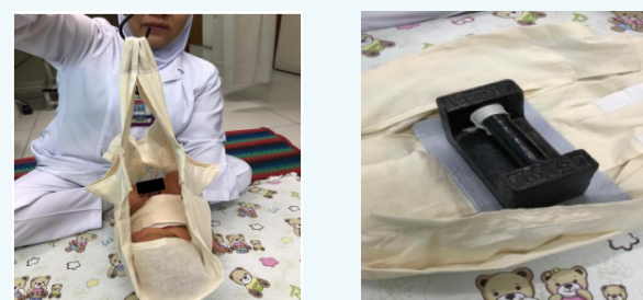
Gambar Rajah (b): proses kerja menimbang dirumah dan proses verifikasi maksima berat yang dapat ditampung oleh kain blaco (pemberat standard 5 kg)
